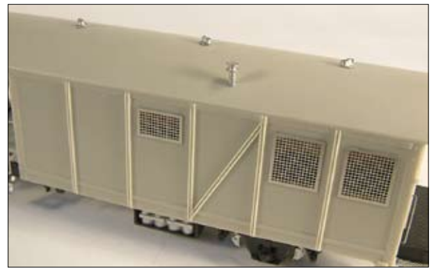
Foto 2: Dakluchters en schoorsteen
