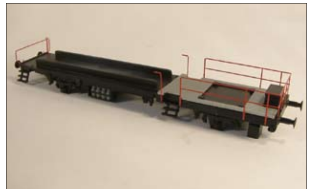
Foto 26: Plaatsen (gebogen) hekwerken
