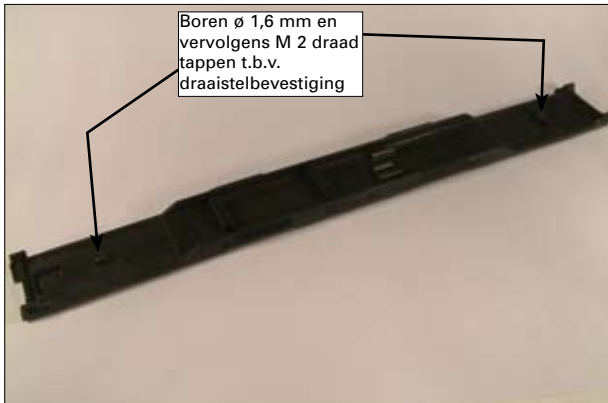
Foto 3: ø 1,6 mm te boren en M2 draad tappen
