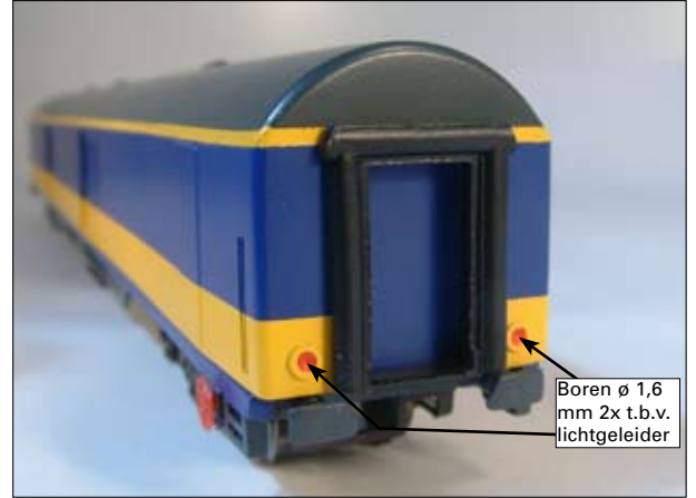
Foto 2: gaten t.b.v. sluitlichten
