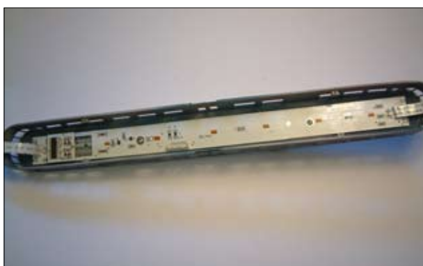
Foto 35: Artitec printplaat gemonteerd in kap
