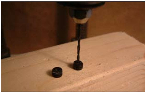
Bild 41: bohren der zwei Rollen \varnothing 1,5 mm
