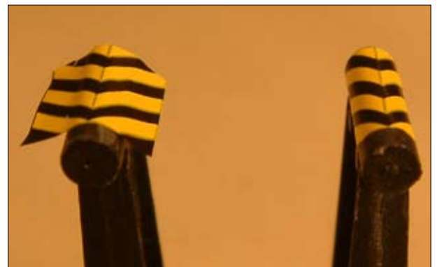
Bild 6: abrigen der Warnstreifen am Stützstempel
