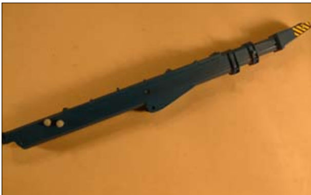
Bild 47: Hauptausleger ineinander geschoben
