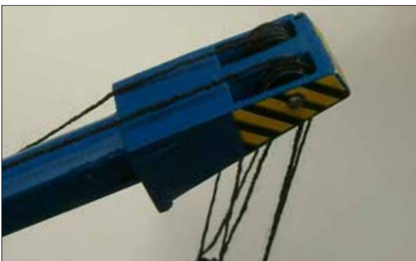
69: Extrémité de bras de levage avec câble
