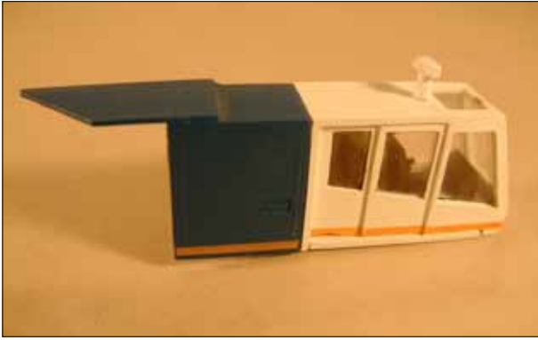
53: Assemblage cabine sur bloc technique gauche
