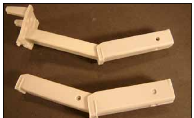
20: Montage du bras télescopique de contrepoids
