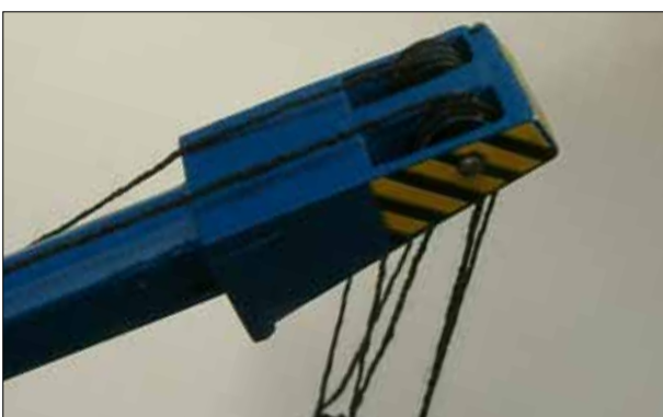
69: Extrémité de bras de levage avec câble
