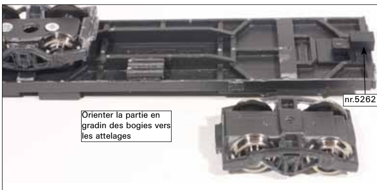
Photo 5: châssis du wagon avec boîtier Symoba et Henricot bogie
