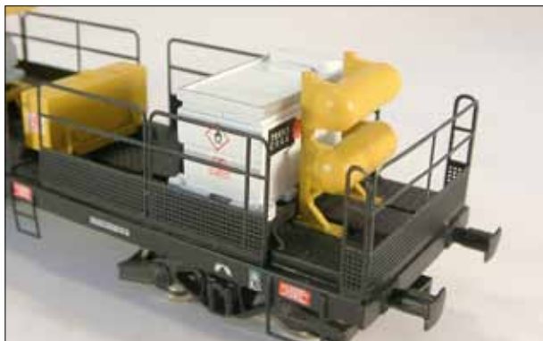
Photo 13: Inscriptions sur réservoir de gazole, d'huile et lon-
